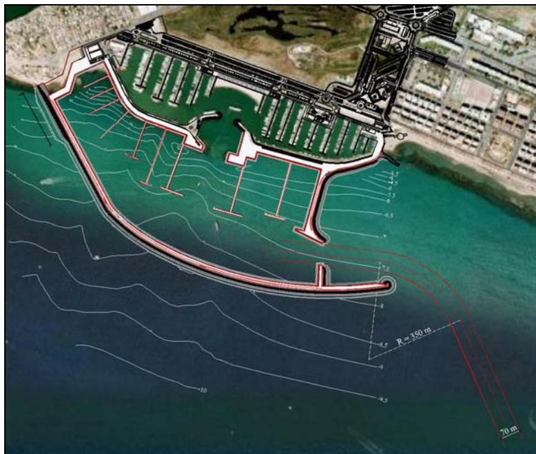
*Figura 2.2 – Raggio di curvatura del canale del canale di accesso*
